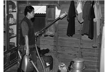
เครื่องดูดยุง : ใช้ดูดตามแหล่ง เกาะพัก เพื่อลดประชากรยุง พาหะ และประเมินผลงาน ควบคุมยุง
